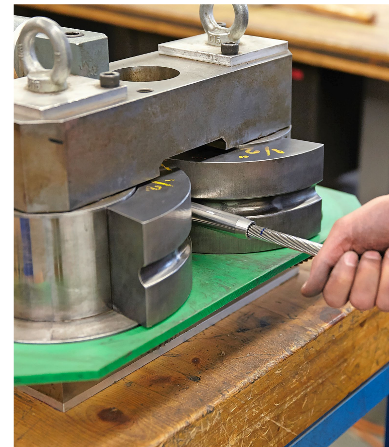
Verarbeitung eines Architekturseils: Auf das vielfältig einsetzbare Edelstahlteil wird ein Gewinde aufgewalzt.
