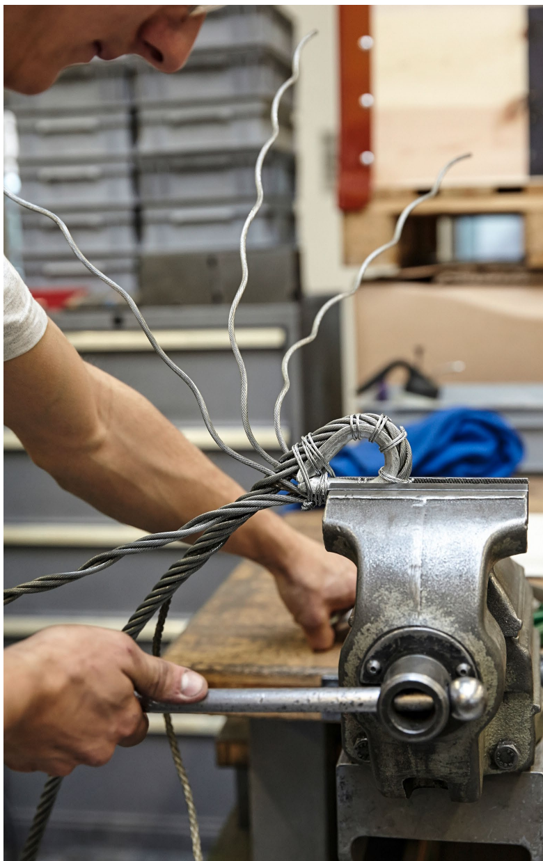
Spleissen eines Stahlseils: In Handarbeit entsteht ein Schlaufenpleiss. Jakob bewahrt diese Tradition des Seilerhandwerks.
