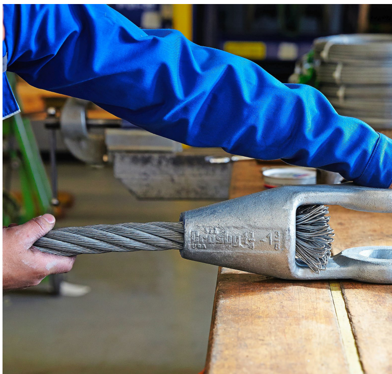
Konfektion eines Drahtseils: Das Seilende wird mit einem Vergusskopf versehen, dies im sogenannten Heissverguss-Verfahren.
